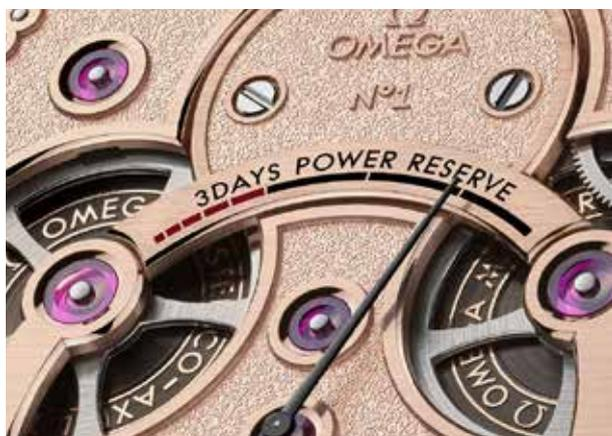
L'indicatore dell'autonomia residua, nella parte posteriore del Calibro 2640, è ampio e ben leggibile. Si nota la zona rossa che avverte come l'autonomia residua sia scesa sotto la soglia che garantisce la migliore costanza di marcia. Grazie all'adozione di due bariletti l'autonomia complessiva è di circa 72 ore, più o meno 3 giorni.
