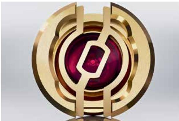
Persino il dispositivo antiurto è stato totalmente riprogettato, nel Calibro 3235. Il perno dell'ancora poggia su un rubino a sua volta collegato a questo minuscolo dispositivo. L'impressione è che questo antiurto sia in grado di assorbire meglio gli urti con inclinazione intorno ai 45° e che comunque la maggiore escursione protegga meglio anche dagli urti verticali e laterali.
