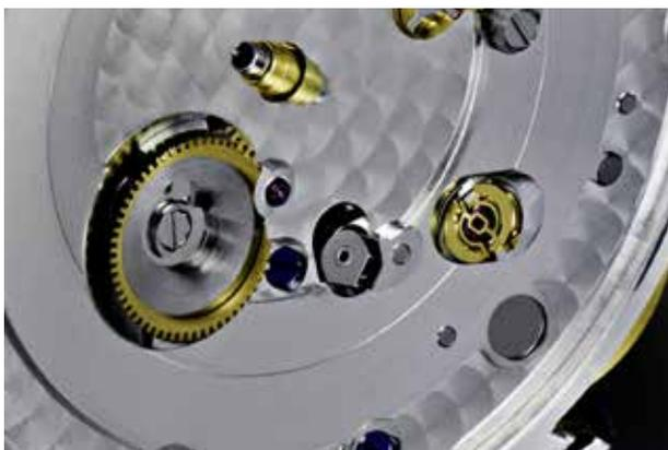
Nel dettaglio, il sistema di gestione del datario nel Calibro 3235. La molla a spirale sostituisce la classica molla lineare ed è sagomata per non creare alcun problema anche nel caso la correzione venisse fatta nelle ore solitamente "proibite", fra le 22 e le 2 della mattina. Anche l'elemento triangolare (a fianco della vite blu), che tiene in sede l'anello del datario dopo lo scatto, può spostarsi avanti o indietro senza problemi.
