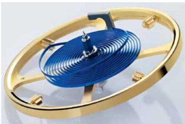
Il bilanciere del Calibro 3235 con la spirale Parachrom blu. La regolazione dell'anticipo e del ritardo viene effettuata tramite i quattro elementi montati a vite. Si agisce a coppie per regolare il momento di inerzia. L'elemento verticale alla fine della spirale, invece, regola tramite una vite l'escursione verticale della spirale stessa nella sua parte terminale.
