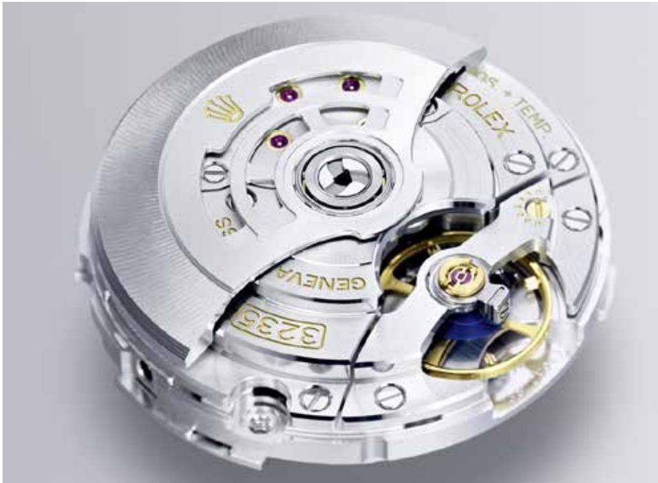
Il Calibro 3235 di Rolex è straordinariamente ricco di soluzioni innovative. Ad esempio, si nota che agendo sulla vite dorata alla destra del bilanciere e su quella verticale davanti al dispositivo antiurto è possibile regolare in maniera finissima la posizione del bilanciere. La massa oscillante, ora, è fissata con una sola vite centrale che necessita di uno strumento specifico.
