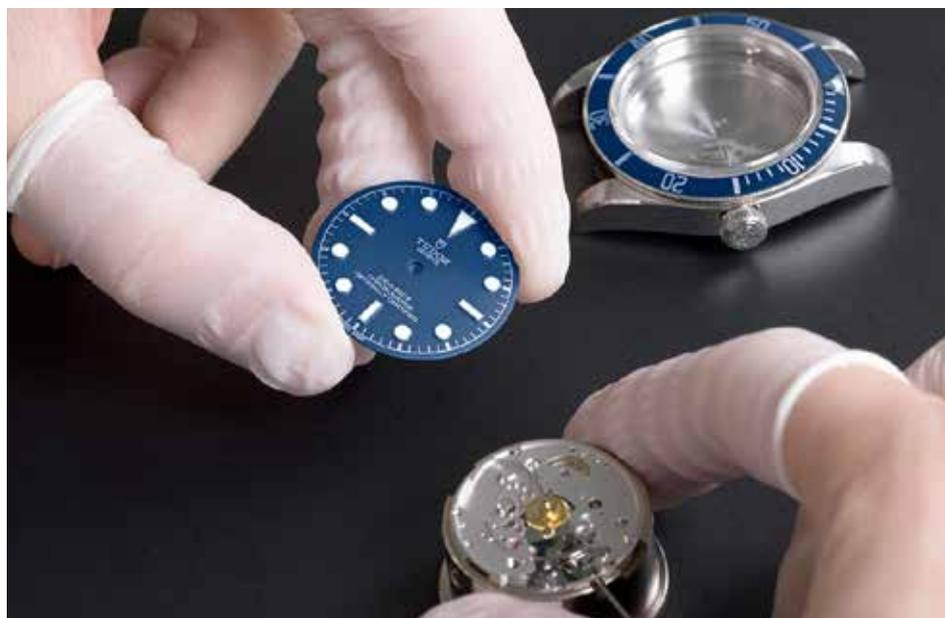
Il quadrante prima d’essere montato sul movimento. Il tutto verrà poi inserito all’interno della cassa e sottoposto ad una serie di test su specifiche Tudor, ancor più severe di quelle – effettuate sul solo movimento – imposte dal Cosc per ottenere il certificato ufficiale di cronometro.
