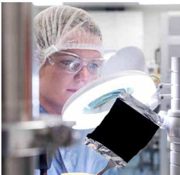
Una fase di lavorazione del Vantablack®, che è un marchio registrato dall'inglese Surrey NanoSystems. Il deposito di nanotubi di carbonio è stato effettuato su un foglio "accidentato" di alluminio. Eppure anche in foto ci si rende conto di come il nero praticamente assoluto faccia scomparire le rugosità del foglio d'alluminio. (Foto courtesy Surrey NanoSystems).
