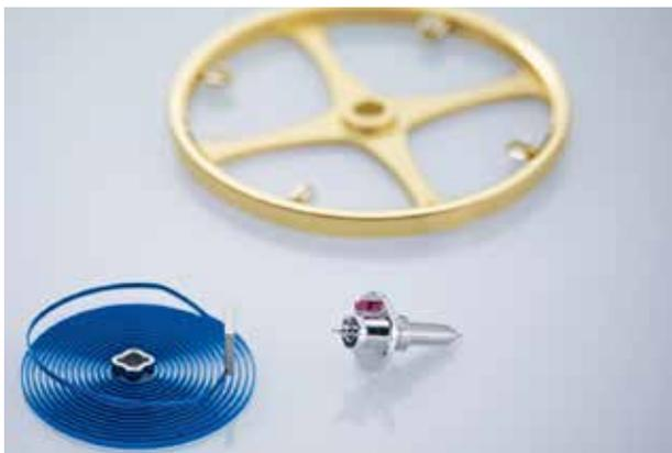
In primo piano il perno dell'organo regolatore, formato da bilanciere e spirale. Il perno viene montato con lo spinotto in rubino verso il basso. Lo spinotto ingaggia, ad ogni semi-oscillazione, l'occhiello dell'ancora che conseguentemente di muove sul proprio perno trasmettendo il moto alla ruota di scappamento.
