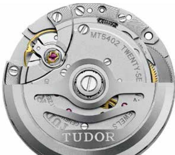
Il Calibro MT 5402 (MT sta per Manufacture Tudor) è progettato e realizzato “in casa”. Ha un diametro leggermente inferiore al Calibro MT 5612 usato in molti altri Tudor. Restano invariate le caratteristiche di base che comprendono il bilanciere a inerzia variabile (che consente una regolazione particolarmente stabile nel tempo), la spirale amagnetica in silicio e la notevole autonomia di circa 70 ore.
