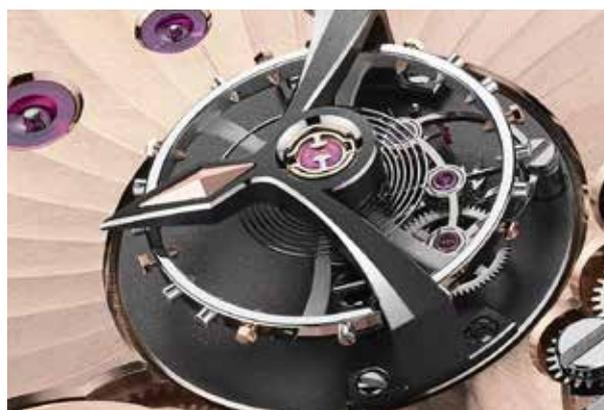
La gabbia del tourbillon è realizzata in titanio successivamente ricoperto di ceramica nera. I profili inclinati vengono lucidati a mano. Si noti il complesso bilanciere con viti per l'equilibratura e per la regolazione ad inerzia variabile dell'anticipo e del ritardo. Non mancano la spirale in silicio, lo scappamento Co-Axial e i materiali che garantiscono all'orologio una insensibilità pressoché totale a eventuali campi magnetici.
