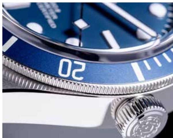
Si nota, in questa inquadratura, il solido tubicino per garantire la tenuta stagna della corona. Si tratta di un tubicino d'acciaio piuttosto spesso, calettato (ossia inserito a pressione) nella cassa. La corona viene avvitata sulla parte superiore del tubicino, filettata, serrando in tal modo le guarnizioni di tenuta. È bene non esagerare mai, nello stringere, per evitare danni alle guarnizioni.
