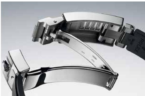
Il fermaglio Glidelock è un piccolo capolavoro di ingegneria meccanica applicata all'ergonomia, ossia alla comodità e facilità d'uso. La parte terminale sinistra ruota leggermente sul perno posteriore, facilitando in tal modo l'apertura e il sollevamento della parte destra. Nel caso dello Yacht-Master 42, la chiusura è realizzata in oro bianco.
