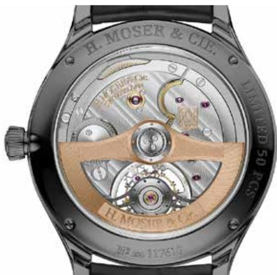
Il fondello dell'Endeavour Tourbillon Vantablack® Black Hands. Per questo modello Moser ha scelto un movimento meccanico a carica automatica con molte parti (gabbia del tourbillon, ruota della gabbia, ponte del bilanciere e ponte dello scappamento) realizzate in una lega di alluminio solitamente usata nell'industria aeronautica. Notare il rubino su cui è montato l'asse del bariletto: è incastonato in oro e fissato al ponte tramite tre viti.
