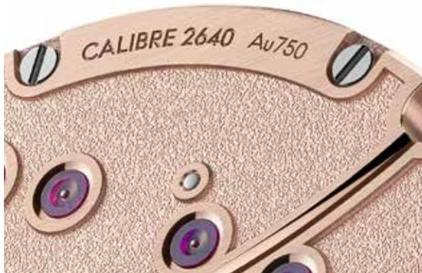
L'impressionante qualità delle finiture. Si nota la superficie di base che è granulata, mentre le superfici dei rilievi sono spazzolati. Tutti i profili inclinati vengono lucidati a mano. Si tratta di una lavorazione nata non per motivi decorativi, ma funzionali. I profili inclinati e lucidati (una tecnica detta anglage) garantiscono infatti che non si creino polveri metalliche dannose per i ruotismi.
