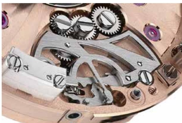
È spettacolare, sia dal punto vista estetico sia da quello tecnico, persino il componente per passare dalla ricarica manuale dei due bariletti alla sincronizzazione dell'ora. Anche in questo caso l'ingrandimento consente di apprezzare la qualità delle lavorazioni.
