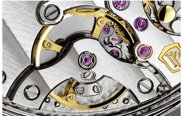
Il ponte passante, fissato da due viti, del bilanciere Gyromax ad inerzia variabile. Per variarla si agisce su due coppie di piccole masse asimmetriche in oro. È un tipo di regolazione particolarmente stabile nel tempo. La molla a spirale è realizzata in silicio. Al centro uno dei due rubini all'interno dei quali si muove l'asse del bilanciere, con il relativo sistema antiurto.
