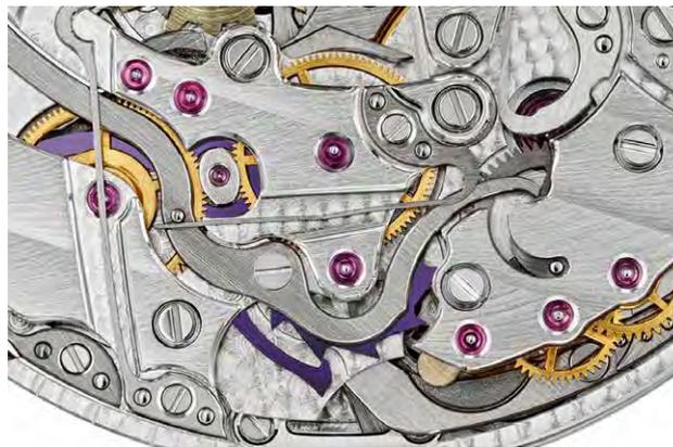
Il dispositivo per i secondi saltanti è realizzato con largo uso di silicio, qui riconoscibile per il colore viola. Si è preferito il silicio per la sua ridottissima massa (minor consumo d'energia), per la sua durezza che, in accoppiata con le proprietà autolubrificanti, riduce il rischio di consumo dei componenti, che vengono azionati ogni secondo (86.400 volte al giorno). L'insensibilità del silicio alle variazioni di temperatura, inoltre, garantisce la massima costanza di marcia.
