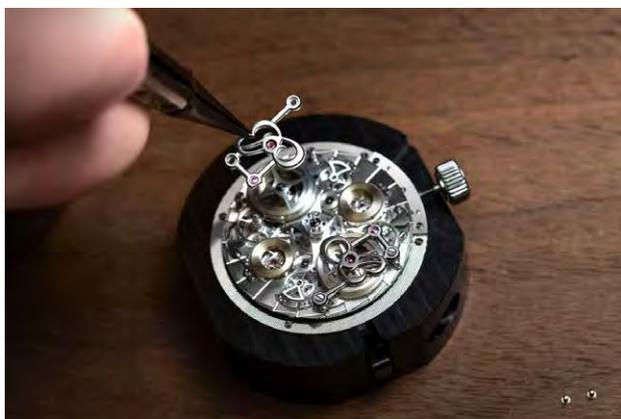
La collocazione del ponte di un bariletto a forma di lettera B. Va ricordato che il calibro è composto in pratica da due movimenti secondari indipendenti, ciascuno con il proprio bariletto, il proprio treno del tempo e il proprio organo regolatore, collegati da un differenziale che determina la media nella velocità di rotazione dell'intero sistema. In questo modo si assicura il più possibile la costanza di marcia.
