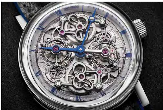
Lo spettacolo offerto dal Breguet Classique Double Tourbillon sul lato quadrante è un'ineccepibile dimostrazione di virtuosismo tecnico ed estetico. Il calibro 588N, numerato e firmato, conta 738 componenti montati su 81 rubini. I due bilancieri monometallici con viti di regolazione in oro lavorano a una frequenza di 18.000 A/h. L'autonomia è di 50 ore.
