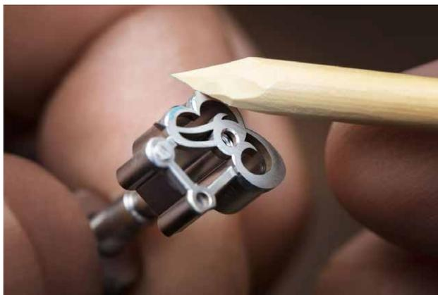
Un'immagine delle lavorazioni realizzate su ogni singolo componente. Operazioni come lucidatura e smussatura a 45° degli angoli sono un sapiente mix di pazienza, manualità e strumenti corretti, non sempre ipertecnologici. L'anglage per esempio si effettua ancora oggi mediante bastoncini di legno.
