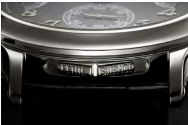
Sull'esterno della cassa, fra le anse a ore 6, il cursore a tre posizioni per attivare la Petite Sonnerie (cursore a sinistra), la Grande Sonnerie (posizione centrale) o, a destra, il silenziamento totale delle suonerie al passaggio. Resta comunque possibile attivare, tramite il pulsante sulla corona, la ripetizione minuti. Le scritte sul cursore sono incise a mano nel platino.
