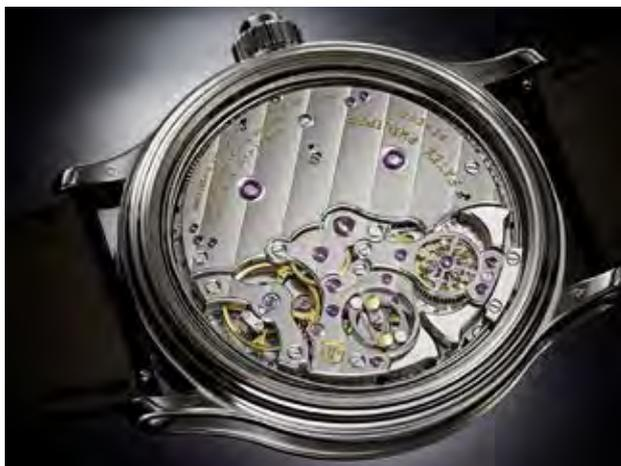
Il fondello trasparente del Ref. 6301P consente di ammirare il movimento, meccanico a carica manuale. In alto il grande ponte cui sono fissate le due coppie di bariletti in serie, sovrapposti. Occupano circa metà del movimento. In basso si notano il fuso che trasmette energia ai dispositivi acustici (a sinistra, sotto un ponte traforato), il volano inerziale che fornisce costanza ai rintocchi e, a destra il bilanciere, il classico Gyromax di Patek Philippe.
